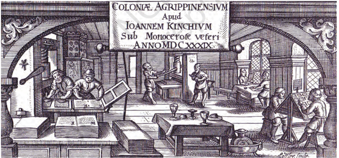
चित्र 8 – एक मुद्रक की वर्कशॉप, सोलहवीं सदी। इस तसवीर से पता चलता है कि सोलहवीं सदी में मुद्रक का कार्यस्थल कैसा दिखायी देता था। सारे काम एक ही छत के नीचे चल रहे हैं। दाएँ छोर पर अगले हिस्से में कम्पोज़ीटर काम कर रहे हैं। बाएँ सिरे पर गैलीज़ तैयार किए जा रहे हैं और धातुई अक्षरों पर स्याही लगाई जा रही है। पृष्ठभूमि में प्रिंटर्स प्रेस के पंच कस रहे हैं और उन्हीं के पास प्रूफरीडर काम में जुटे हैं। बिलकुल अगले भाग में तैयार माल पड़ा है। ये दो-दो पृष्ठ वाले छपे हुए पन्ने हैं जिनकी बाईंडिंग होनी है।
