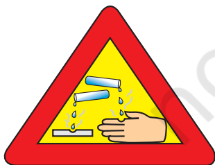
चित्र 2.5 सांद्र अम्ल तथा क्षारक वाले बर्तनों में लगे चेतावनी के चिह्न
